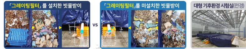
「그레이팅필터」 배수기능의 우수성 검증 시험(시간당 강우량 150mm / 기본 및 쓰레기 도포 2가지 case 시험)
